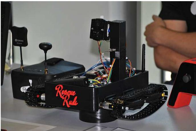
Nach einigen Wochen spannenden Arbeitens ist er schließlich pünktlich zum Finaltag fertig geworden – der RescueRudi. RescueRudi ist ein ferngesteuertes Fahrzeug, mit dem aus sicherer Entfernung eine für Rettungskräfte nicht direkt zugängliche Umgebung inspiziert werden kann.
